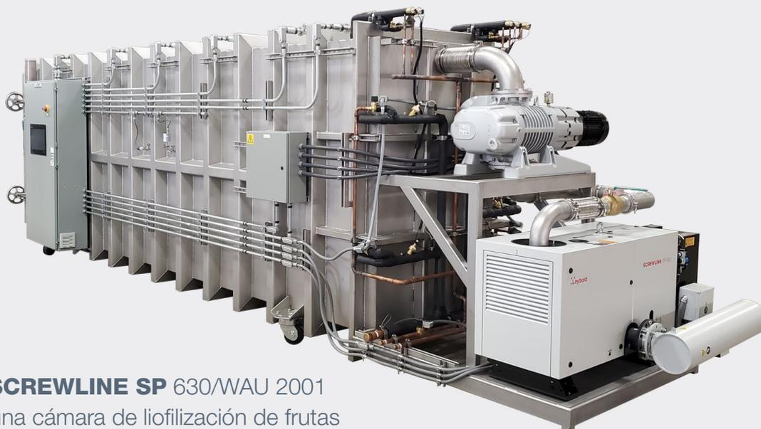
Una bomba **SCREWLINE SP** 630/WAU 2001 instalada en una cámara de liofilización de frutas
